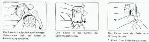
Die Spule in die Spulenkapsel einlegen. Sicherstellen, daß der Faden in Pfeilrichtung abgewickelt.
