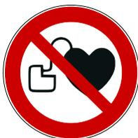
Während des Beschichtens entsteht zwischen Pistole und geerdeten Teilen (Werkstück, Kabine, Boden) ein Hochspannungsfeld, das Fehler bei Herzschrittmachern auslösen kann.
