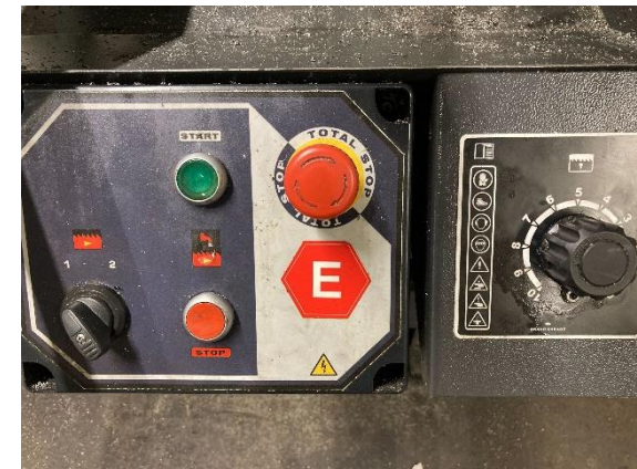
2 Notaus, 6 Schnittgeschwindigkeit wählen, 7 Vorschub einstellen
